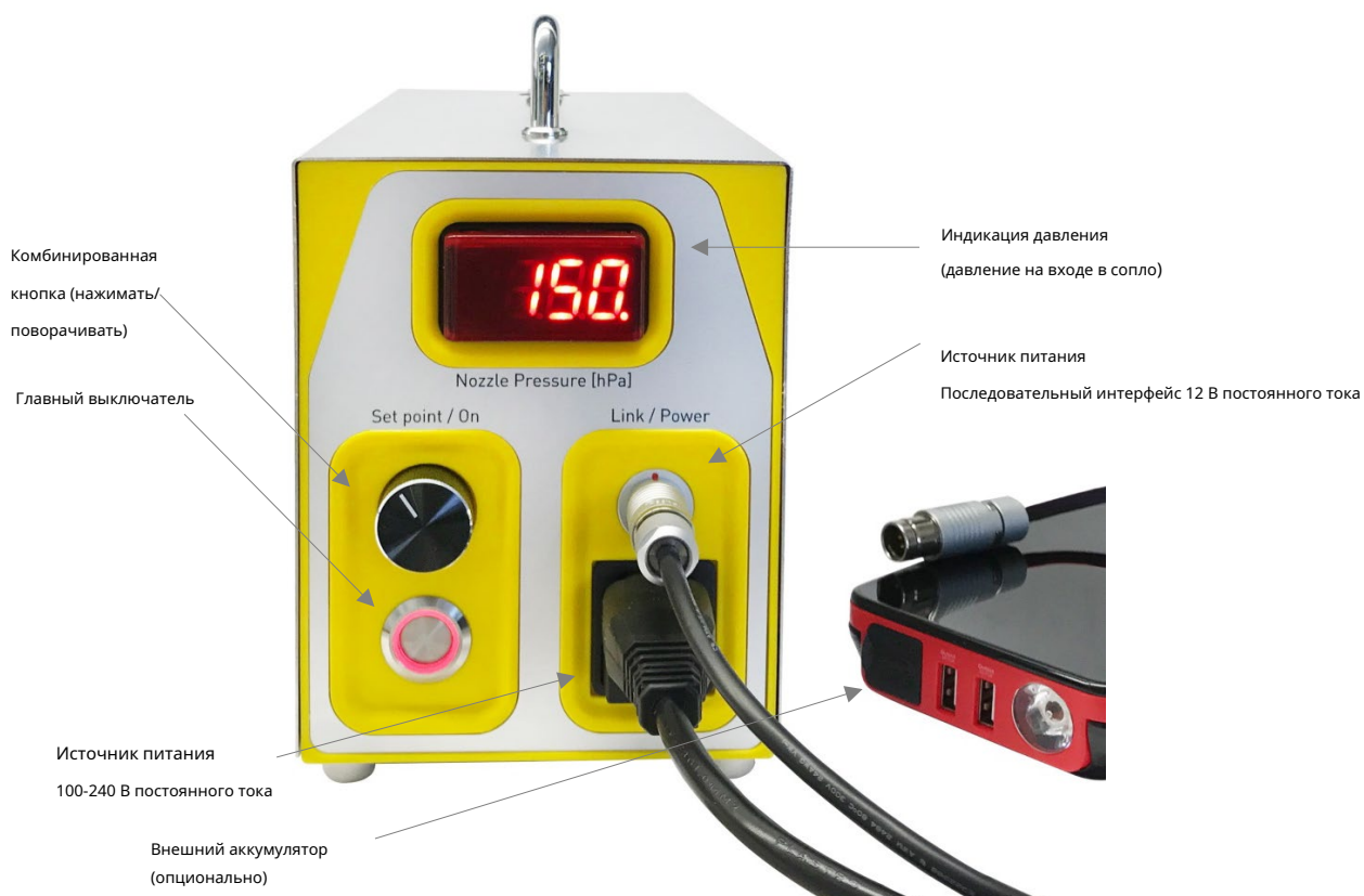
Рисунок 4 - Элементы управления аэрозольного генератора ATM 228
