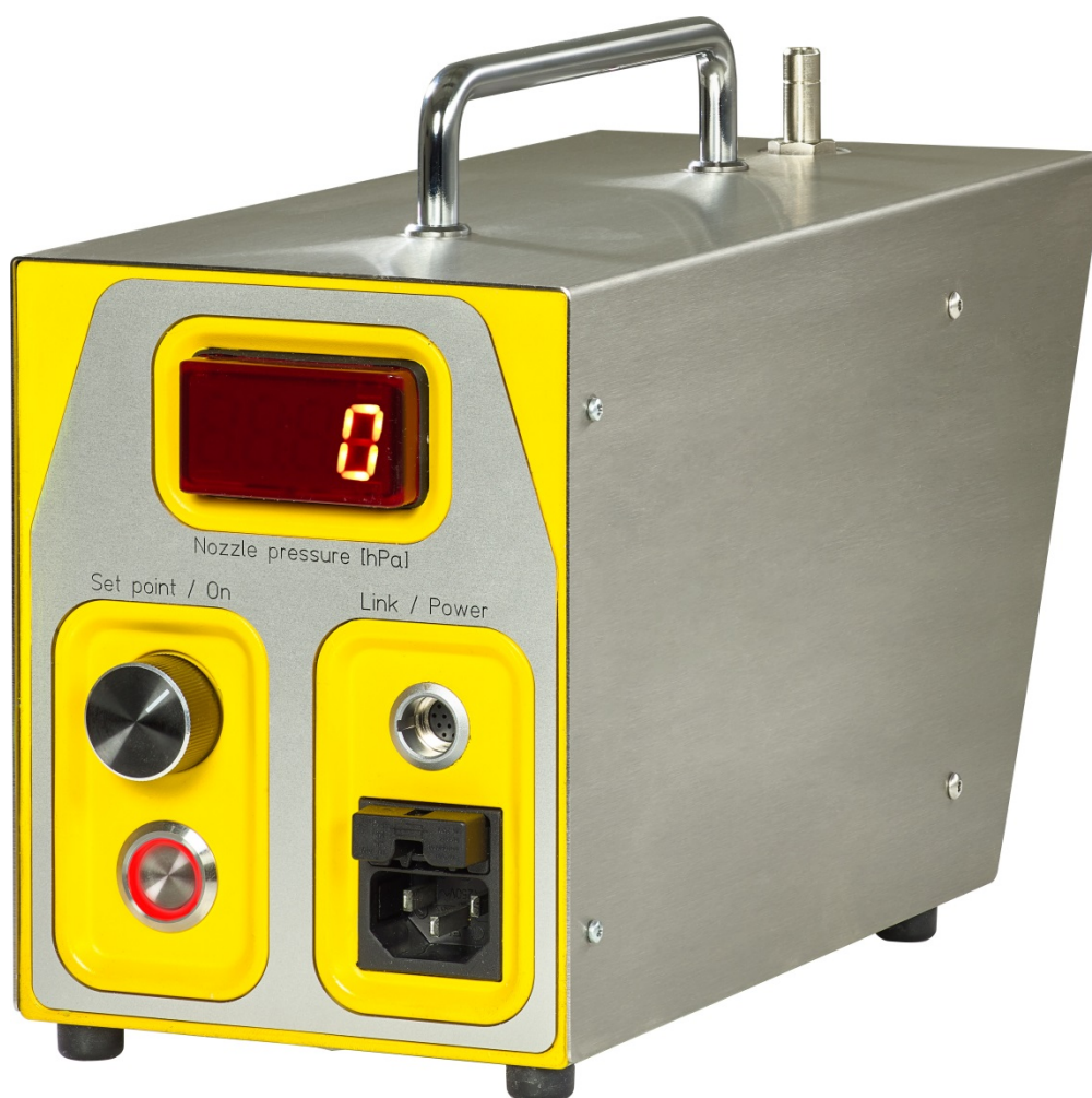
Рисунок 3 - Аэрозольный генератор АТМ 228 с регулировкой объема потока аэрозоля
