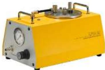
Генератор-распылитель аэрозолей АТМ 231 предназначен для генерации аэрозолей из жидкостей, работает на сжатом воздухе, с погружным соплом, обеспечивает высокую скорость потока.
