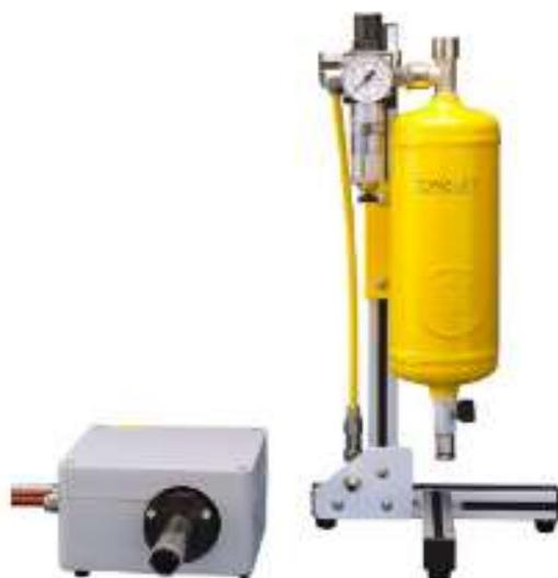
Генератор больших капель LDG 244 предназначен для образования крупных капель из жидкостей, лучше всего подходит для формирования пленок из моторных масел.
