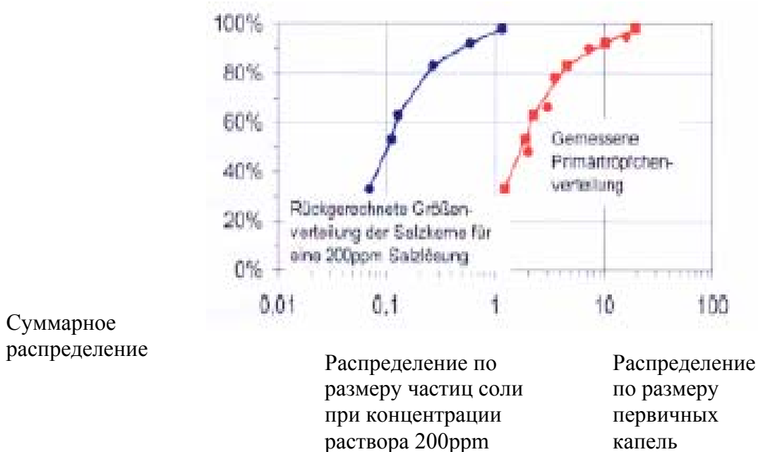
Рис.9. Распределение по размеру частиц соли и первичных капель из упомянутого выше раствора
