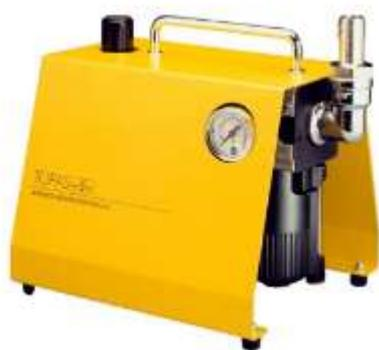
Генератор-распылитель аэрозолей АТМ 210 предназначен для генерации аэрозолей из жидкостей при противодавлении до 10 бар, работает на сжатом воздухе, обеспечивая умеренную и высокую скорость потока.
