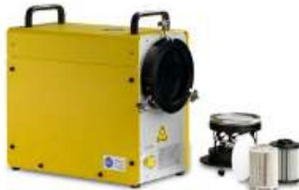
Гравиметрический пробоотборник GMS 141 позволяет удобно определять содержание масла на сепараторах масляного тумана с плоским фильтром на стендах для испытаний двигателей. Отбор проб аэрозолей на нагреваемом фильтре (макс. 120 °С). С датчиком температуры и скорости потока.
