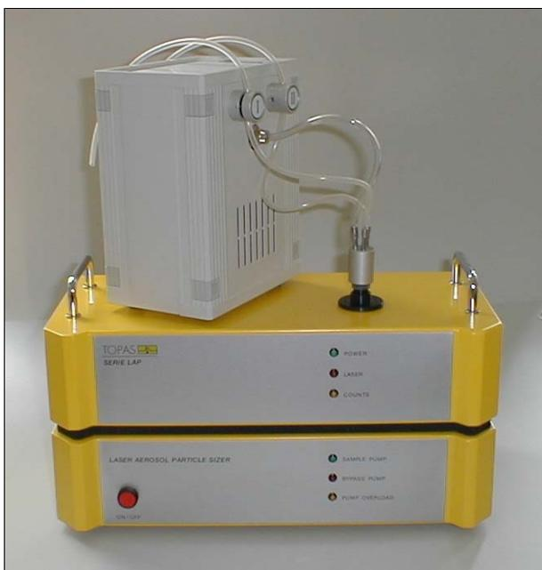
Блок переключения проб SYS 520, управляемый лазерным аэрозольным спектрометром LAP 321/322
