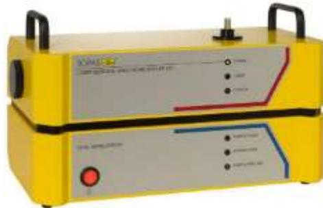
Аэрозольный спектрометр LAP 323 предназначен для анализа распределения частиц по размерам и концентрации в аэрозолях, работает на технологии двойной длины волны.
